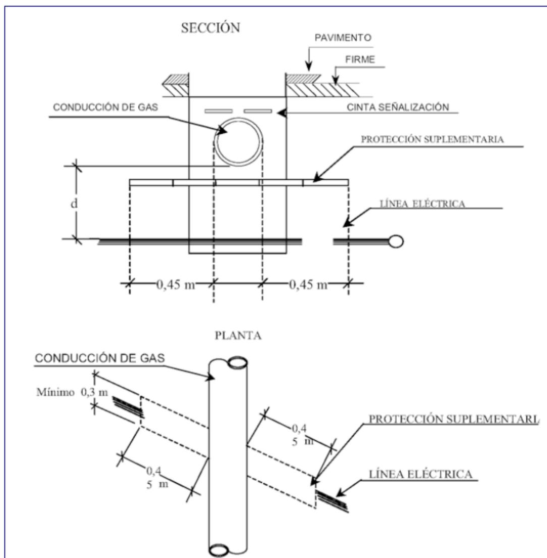
En el caso de línea subterránea de alta tensión con canalización entubada, se considerará como protección suplementaria el propio tubo, no siendo de aplicación las coberturas mínimas
