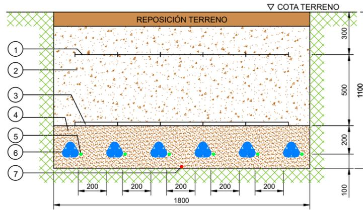
**SECCION ZANJA TIPO EN TIERRA
