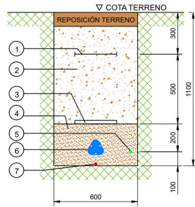
**SECCION ZANJA TIPO EN TIERRA
