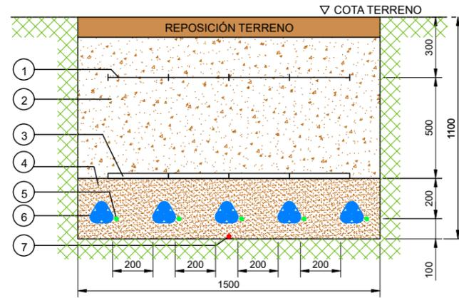
**SECCION ZANJA TIPO EN TIERRA
