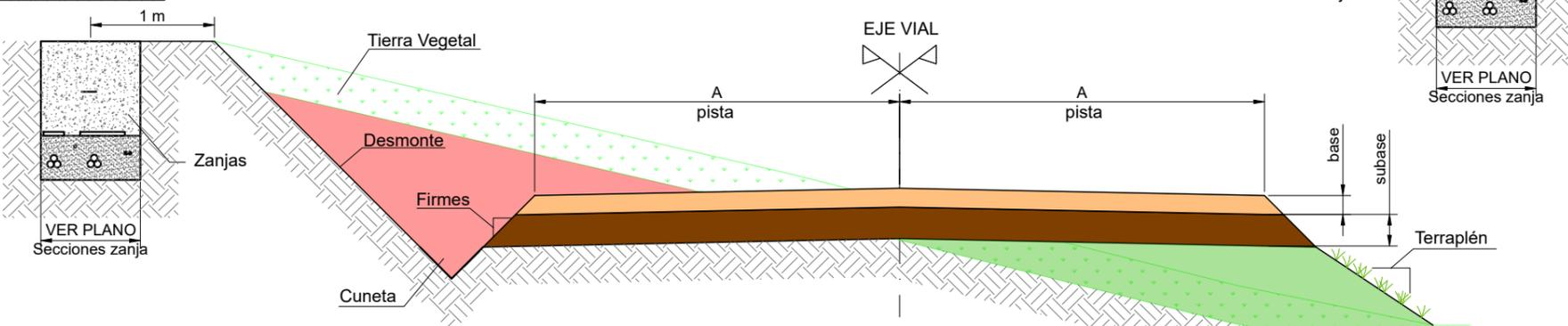
**SECCION TIPO VIAL. DESMONTE Y TERRAPLÉN**
