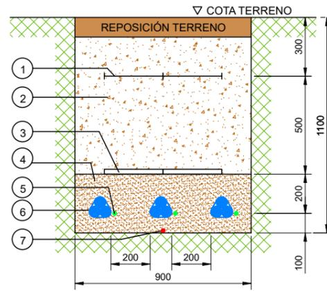
**SECCION ZANJA TIPO EN TIERRA
