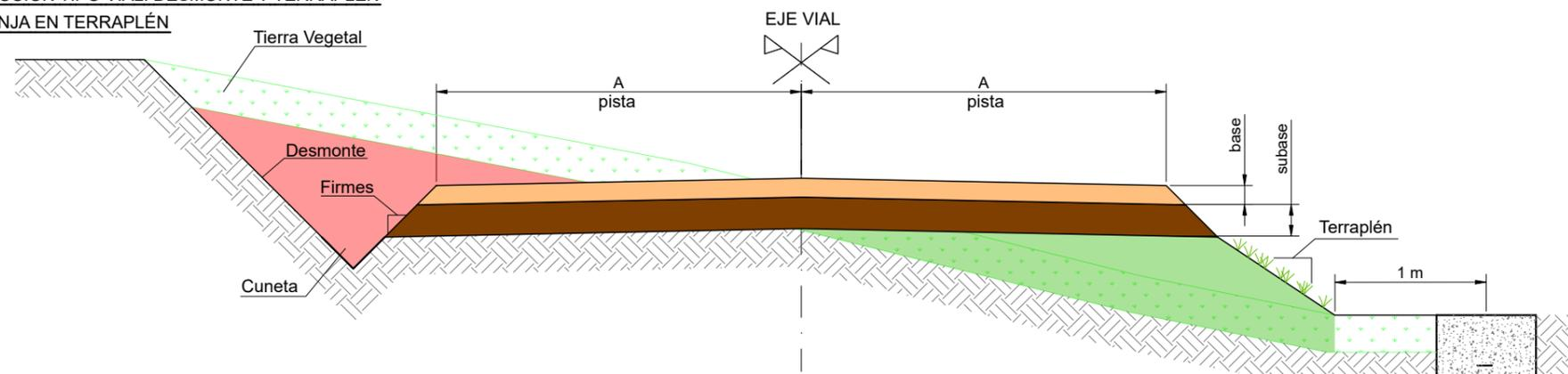
**SECCION TIPO VIAL. DESMONTE Y TERRAPLÉN**
