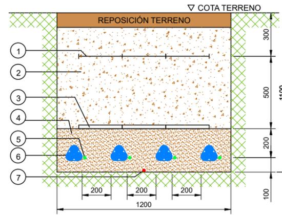
**SECCION ZANJA TIPO EN TIERRA
