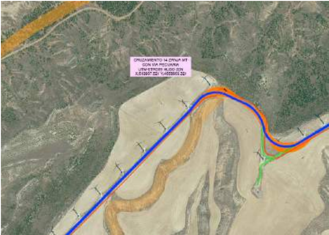
Imagen 3 AfECCIÓN línea eléctrica a vías pecuarias.
