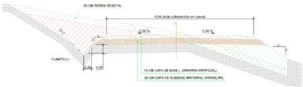
Imagen 4 Sección tipo material granular
