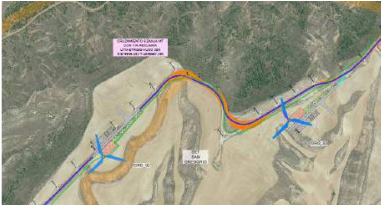
Imagen 3 Afección línea de evacuación a vías pecuarias.
