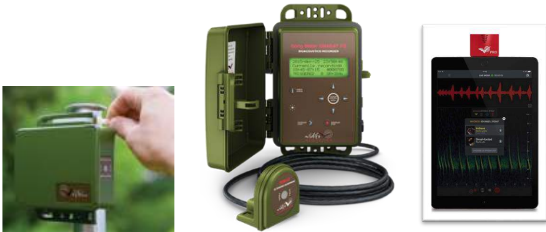
Figura 2. Izquierda y centro: grabadoras de ultrasonidos SM Mini BAT y SM 4 BAT Full Spectrum (Wildlife Acoustics), utilizadas en la estación de grabación autónoma. Derecha: micrófono Echo Meter Touch 2 Pro (Wildlife Acoustics) conectado a una Tablet (iPad, Apple) utilizado en los transectos nocturnos.
