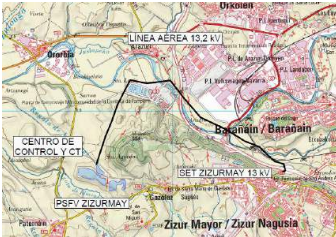
Imagen 1. Localización de la línea de evacuación.
