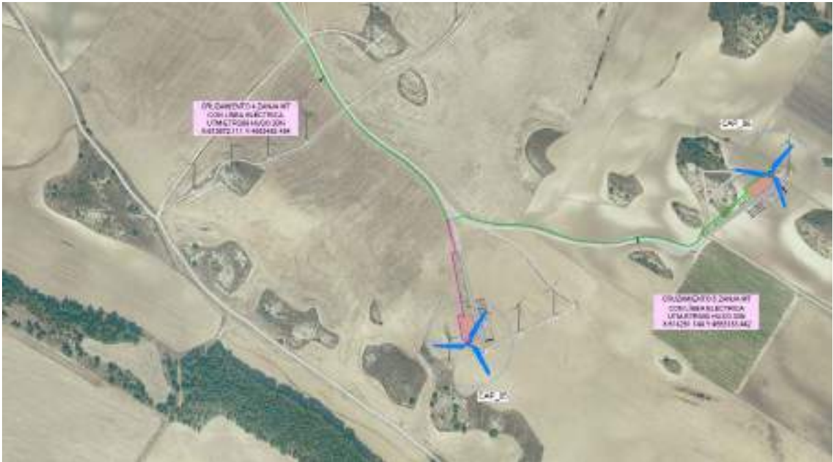
Imagen 2 Afeción línea de evacuación con LAT FERIAL.
