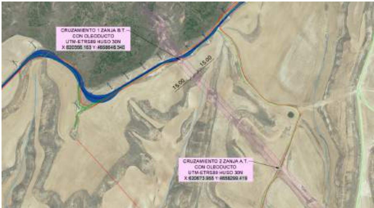
Imagen 1 Afcción línea eléctricas con oleoducto.
