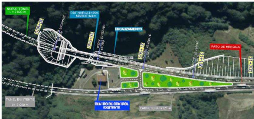
El nuevo túnel de Belate se posiciona de forma divergente al actual, con separaciones entre 29 y 150 m. Tiene una longitud de 2.893 m (67 m menos que el actual).
