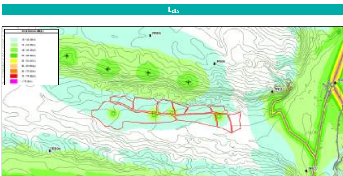
Figura 14: Mapa de niveles sonoros de la futura instalación. Situación acumulada prevista (L día )
