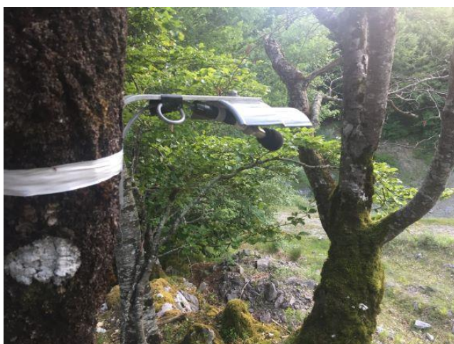
Figura 2. Micrófono de la grabadora de ultrasonidos, colocada en un bosque del interior de la cantera.
