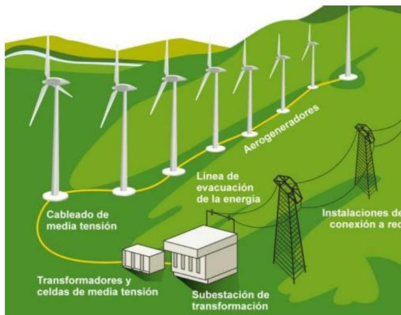
Figura 1: Esquema de una Parque Eólico (Fuente: Greenpeace)
