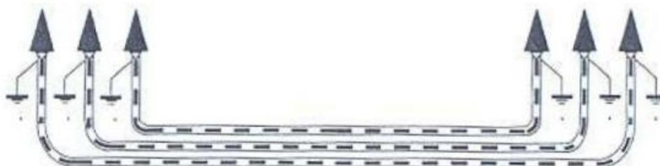
**Figura 15. Puesta a tierra de cubiertas metálicas**
