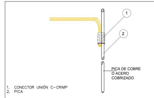
CONEXIÓN TÍPICA ENTRE LA ESTRUCTURA Y PUESTA A TIERRA
