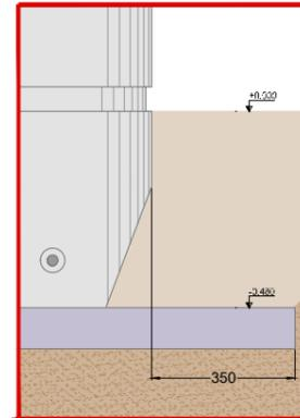
En función de las características del terreno, una vez realizada la excavación, los edificios monobloque se asientan sobre una cama de arena lavada y nivelada de e=100 mm, o bien sobre una losa de hormigón armado y nivelado de e=150 mm (HA-20)
