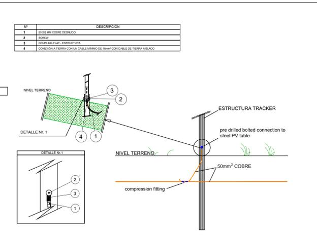
DETALLE CONEXIÓN ENTRE ESTRUCTURAS
