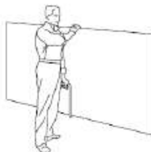
Transporte de placas
