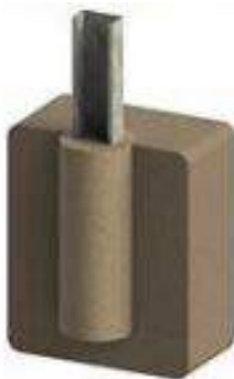
Imagen-croquis de cimentación con preperforación
