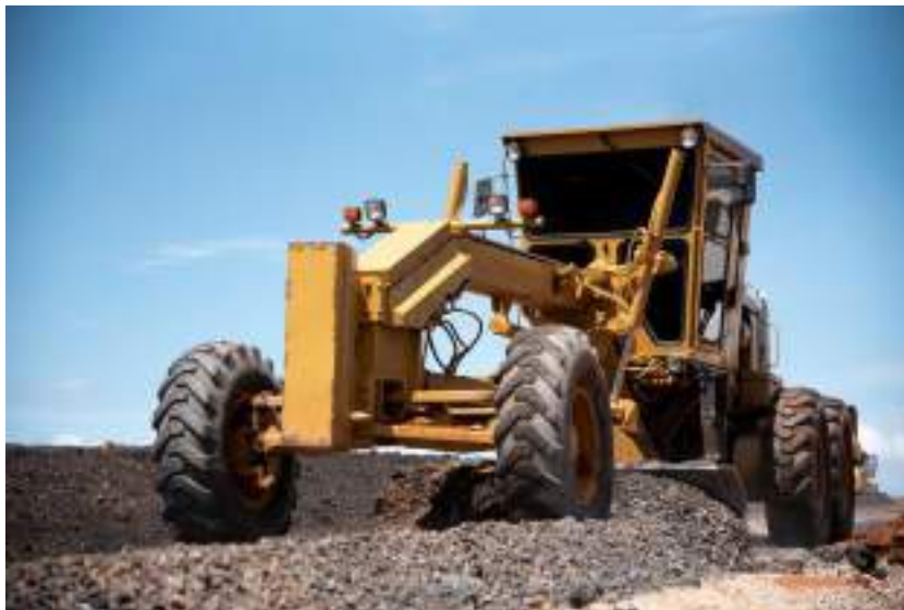
Motoniveladora para preparación del terreno
