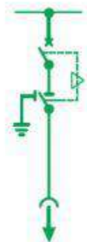
Unidad de protección del transformador
