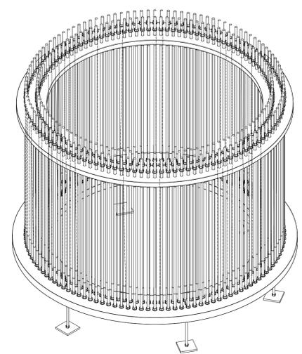
Jaula de pernos con brida inferior simple. Vista Isométrica
