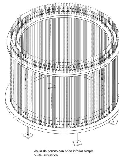
Jaula de pernos con brida inferior simple. Vista Isométrica
