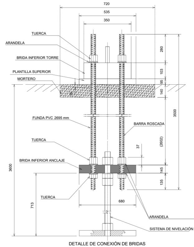
DETALLE DE CONEXIÓN DE BRIDAS
