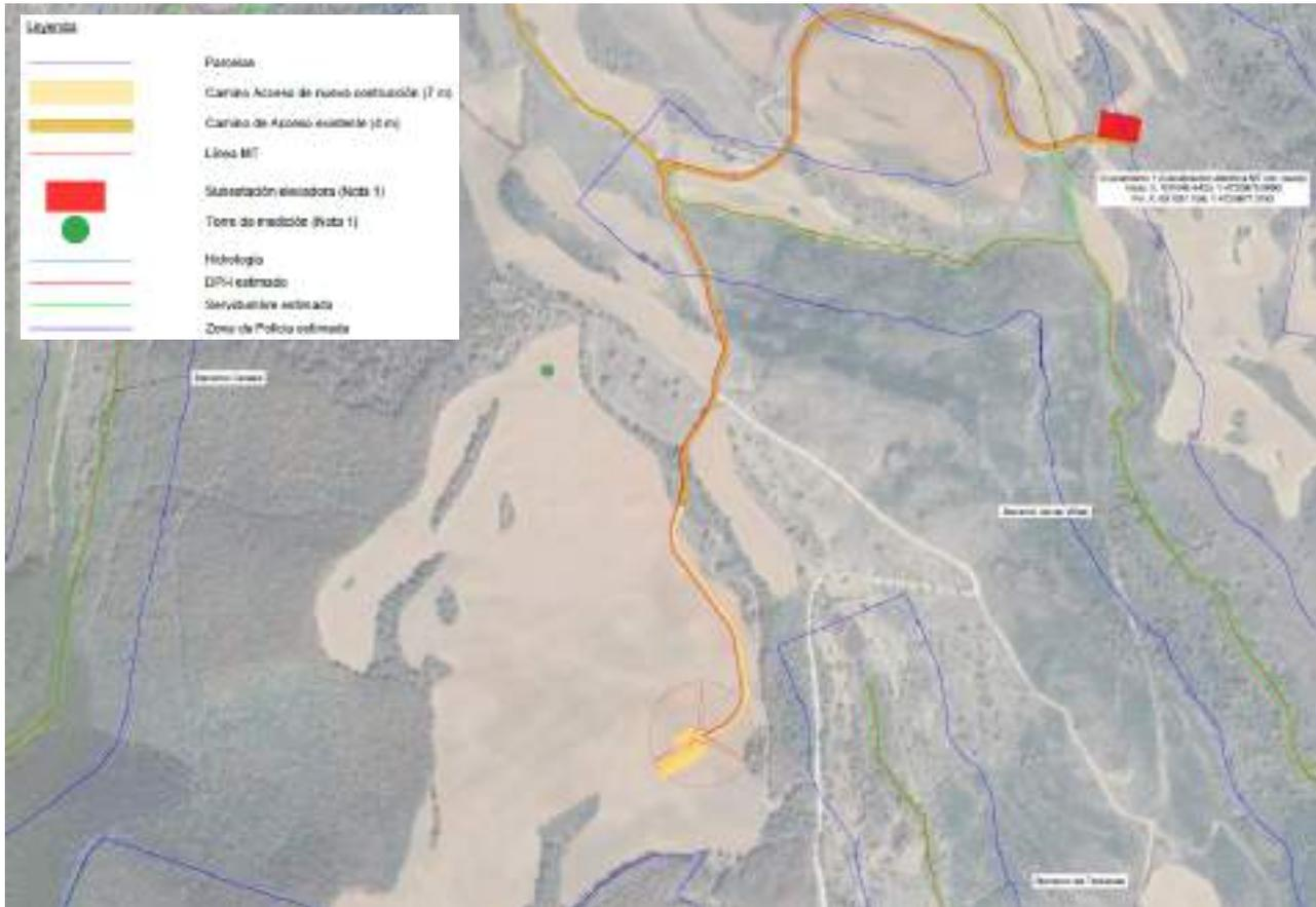
**Figura 7. Afecciones del Parque Eólico a la hidrografía**
