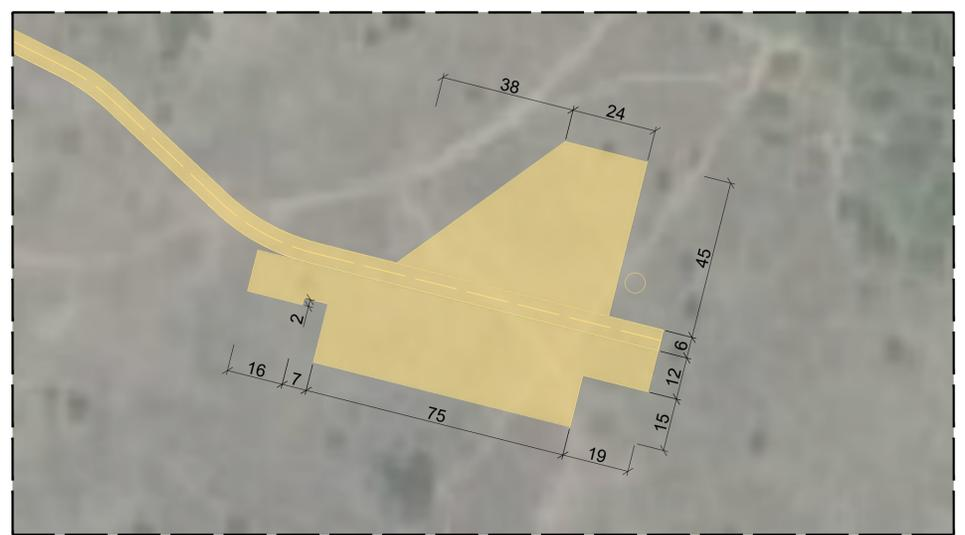
**Detalle 5: Plataforma aerogenerador**
