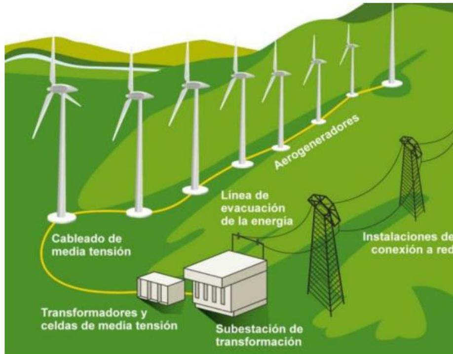
**Figura 2: Esquema de una Parque Eólico (Fuente: Greenpeace)**
