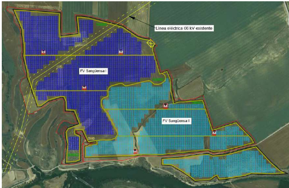
Ilustración 10. Afección línea eléctrica
