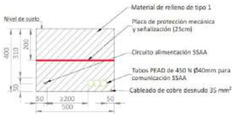
Figura 17 Detalle zanja BT SSAA
