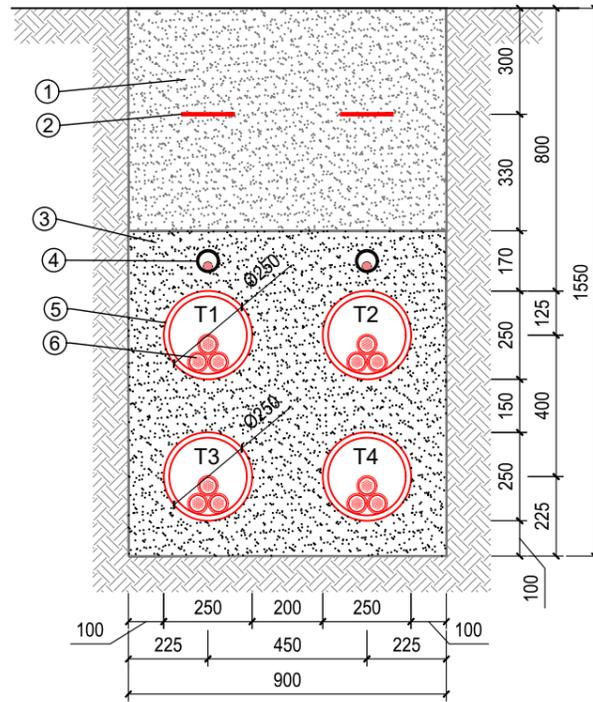
SECCIÓN TIPO ZANJA ENTUBADA
