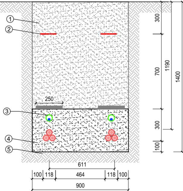
SECCIÓN TIPO ZANJA ENTERRADA
