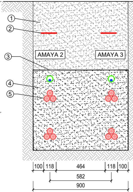
SECCIÓN TIPO ZANJA ENTERRADA
