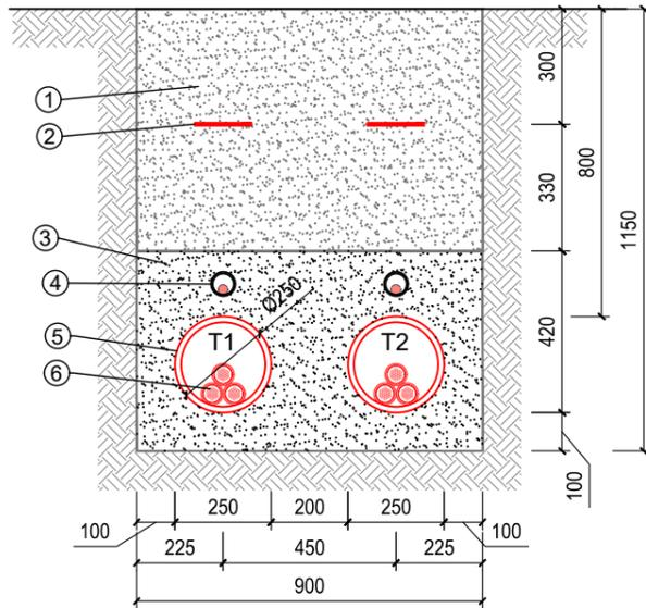
SECCIÓN TIPO ZANJA ENTUBADA
