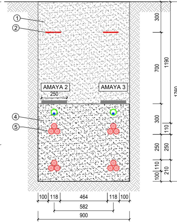
SECCIÓN TIPO ZANJA ENTERRADA
