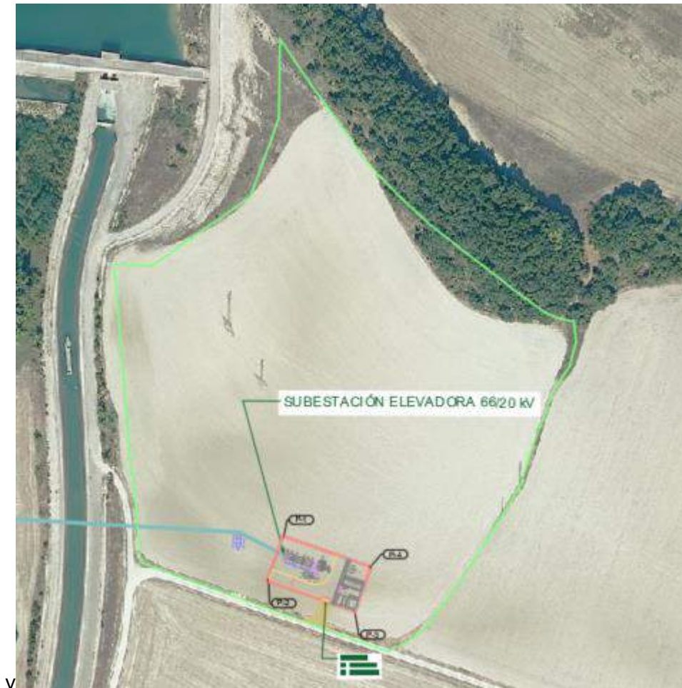
Figura 3: Situación emplazamiento Subestación Elevadora.
