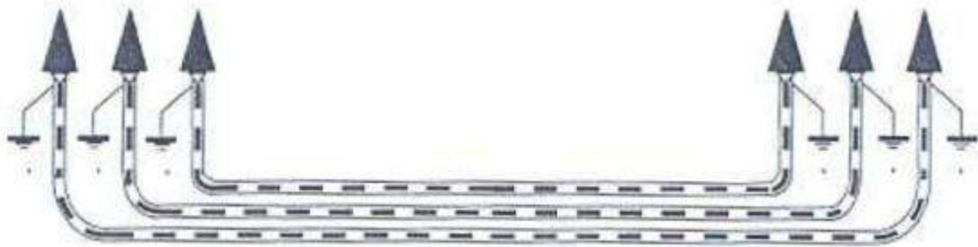
Figura 21: Puesta a tierra de cubiertas metálicas.
