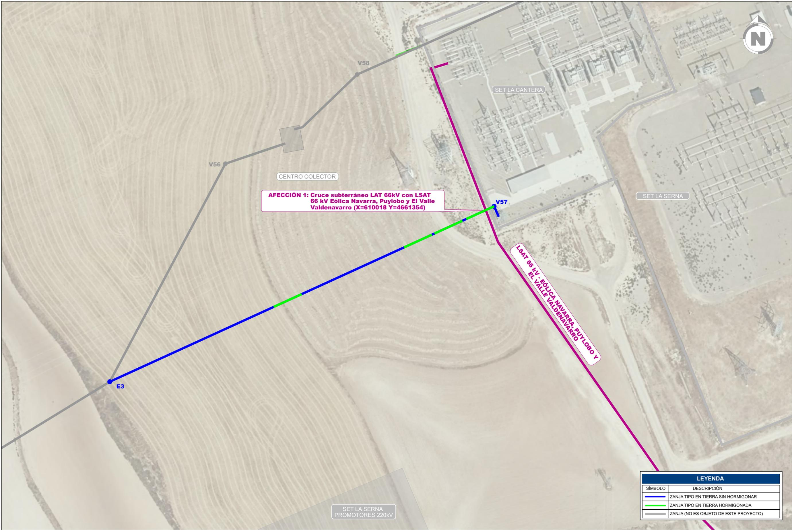
**AFECCIÓN 1: Cruce subterráneo LAT 66kV con LSAT 66 kV Eólica Navarra, Puylobo y El Valle Valdenavarro (X=610018 Y=4661354)**
