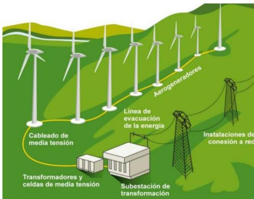
**Figura 1: Esquema de un Parque Eólico (Fuente: Greenpeace)**
