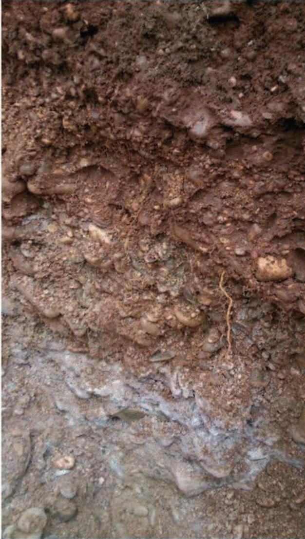
**Ilustración 28: Foto del perfil del suelo de la cantera.**
