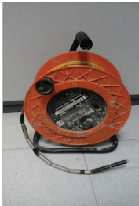
Fotografía 2: Sonda de medida de nivel freático
