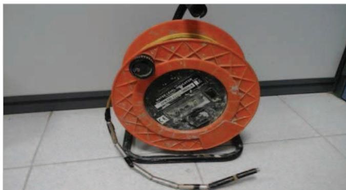
**Fotografía 2: Sonda de medida de nivel freático**
