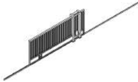
Imagen 4. Detalle de portón de una hoja corredera
