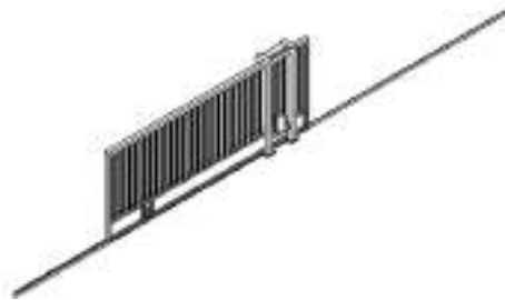
Imagen 4. Detalle de portón de una hoja corredera
