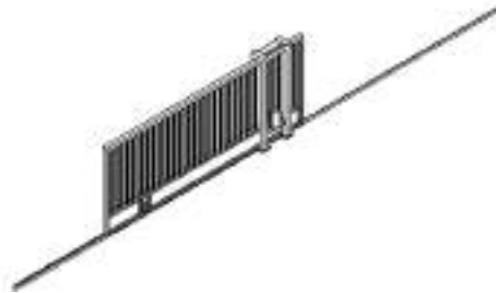
Imagen 4. Detalle de portón de una hoja corredera
