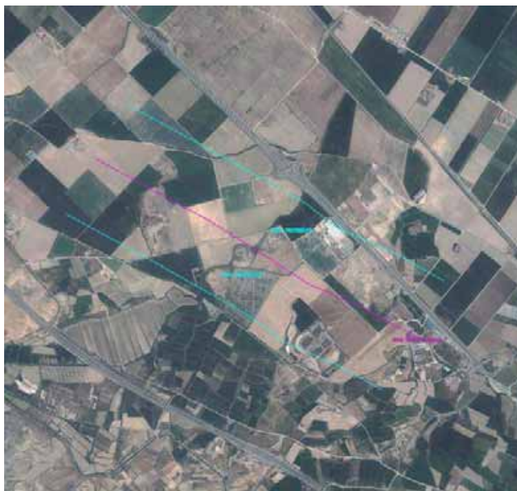
Figura 1: Área preferente para instalación de planta solar fotovoltaica Rosa línea eléctrica 13,20KV, azul área preferente.
