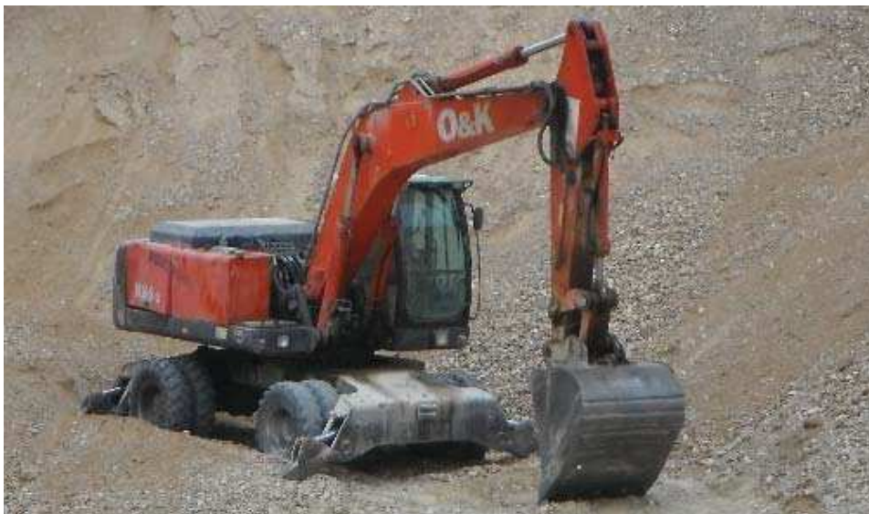
Ilustración 81: Retroexcavadora O&K MH 6.5
