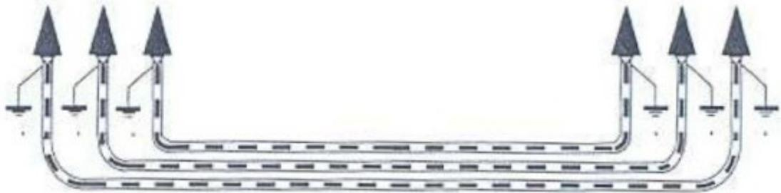
Figura 14: Puesta a tierra de cubiertas metálicas.
