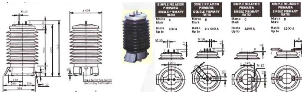
Figura 8. Transformador de intensidad 66kV
