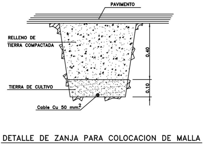
**DETALLE DE ZANJA PARA COLOCACION DE MALLA**
