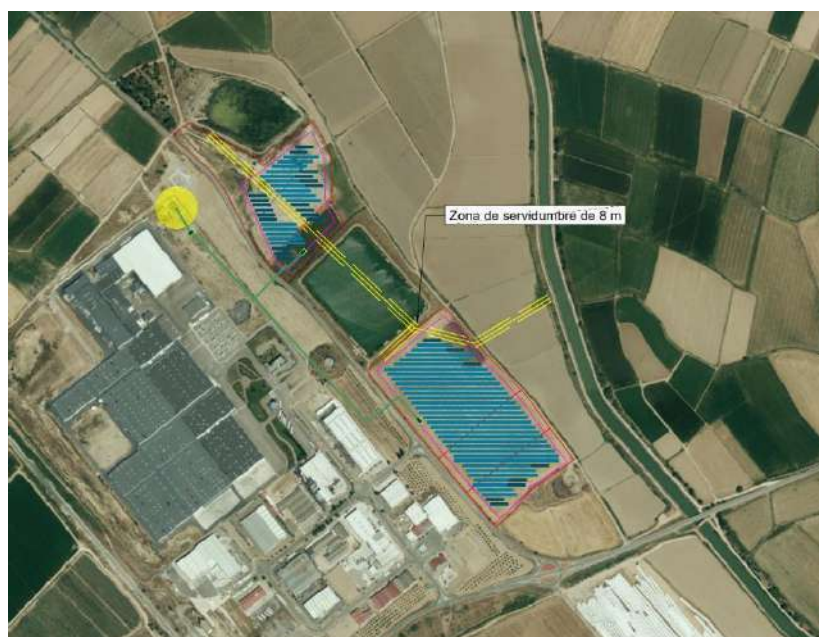
Ilustración 11. Líneas eléctricas en el entorno de la planta
