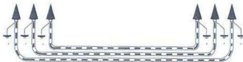
Ilustración 43. Puesta a tierra cubiertas metálicas
