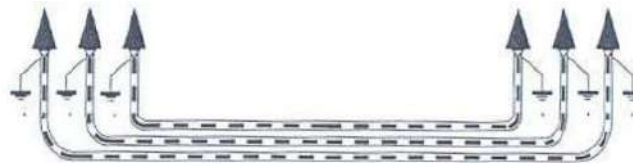
Ilustración 38. Puesta a tierra de cubiertas metálicas
